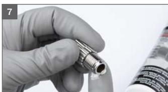
7 Gewinde der Materialmengenregulierschraube einfetten
