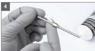
4 Farbnadel im Bereich der Nadeldichtung einfetten
