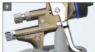
9 Sichtbarer Bereich der Luftkolbenstange einfetten
