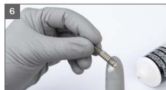
6 Farbnadelfeder einfetten und einsetzen
